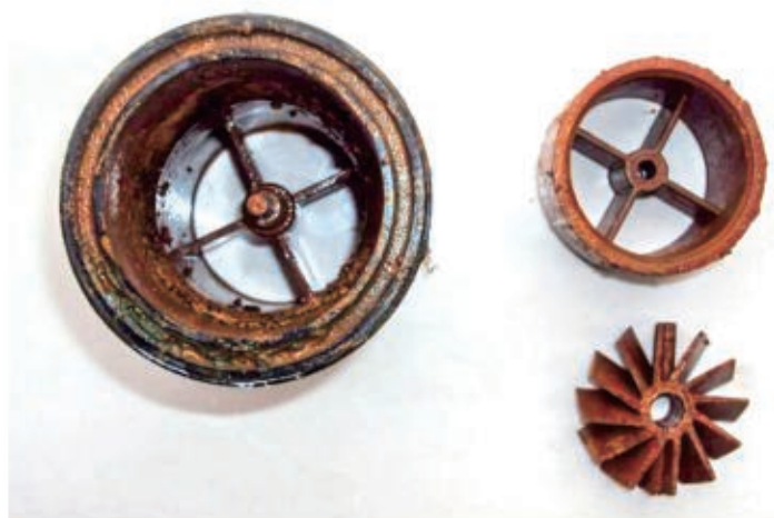
图8-4 流量计涡轮卡住的问题
