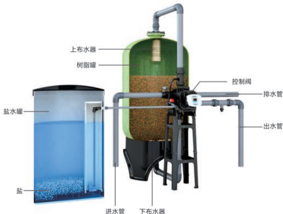
图4-2 单阀侧装的自动软水器
