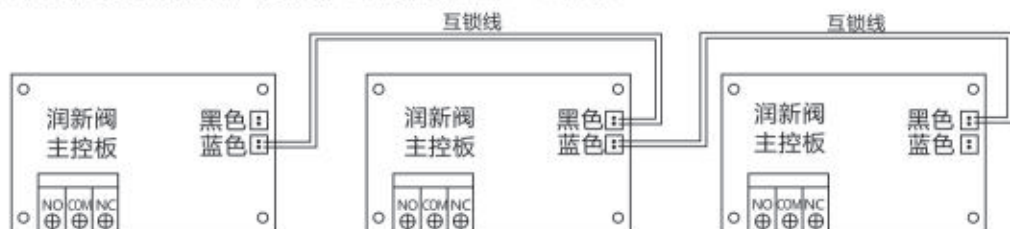
图2-39 同时供水、分别再生系统线路图
