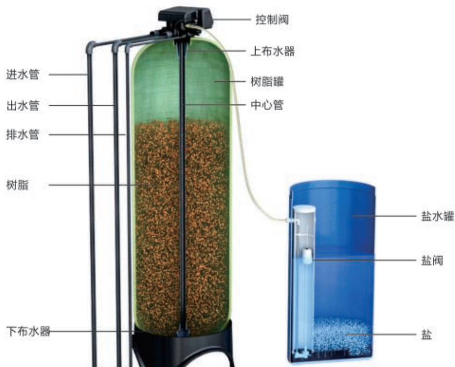
图4-1 单阀顶装的自动软水器
