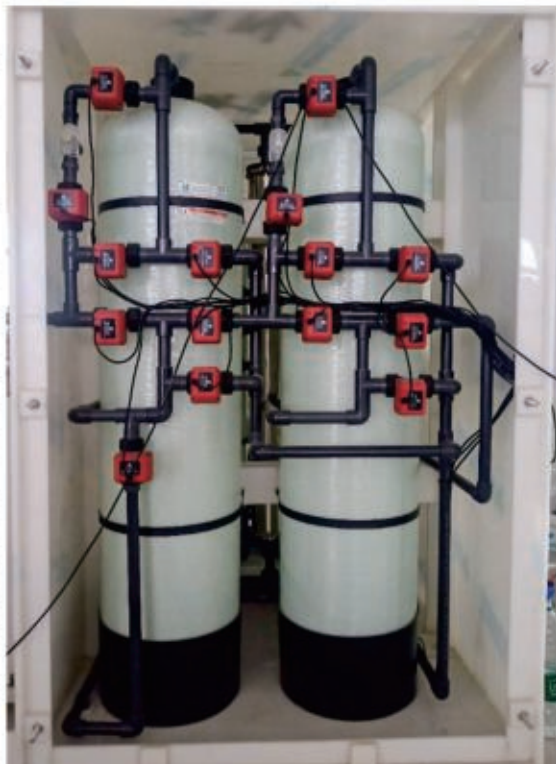
图9-8 球阀用于电镀液重金属回收装置
