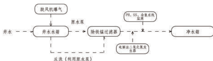
图6-2 水厂曝气过滤除铁锰处理流程
