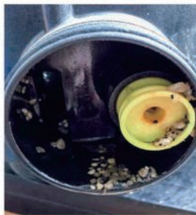
图8-9 射流器被堵塞
