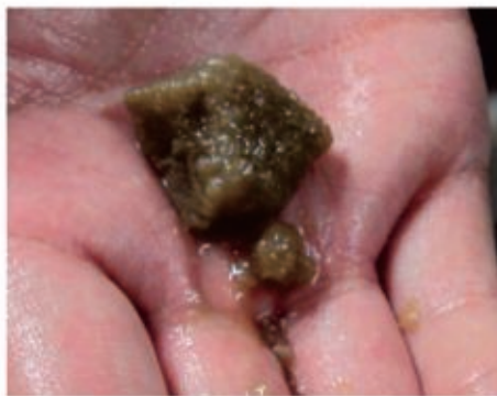
图8-3 有机物污染后的树脂
