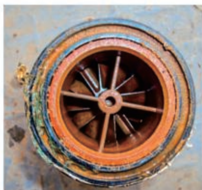
图8-15 流量计叶轮卡死
