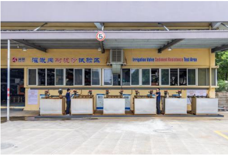
润景灌溉阀耐泥沙试验区
