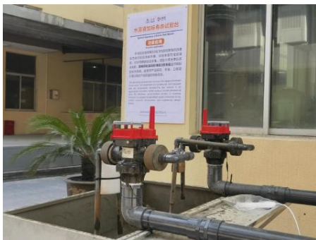
阀门耐水肥溶液试验 (加标 2 倍)
