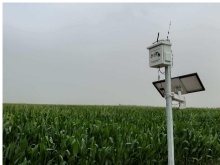
润景 LoRa 出水桩阀应用于大面积玉米灌溉
