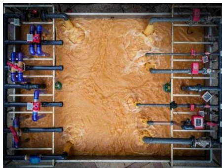
阀门耐泥沙试验 (含沙量 20\text{kg/m}^3 )
